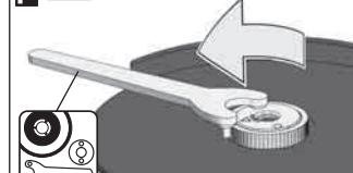
Bei feststehender FIXTEC Mutter Zweilochmutterchlüssel verwenden.
